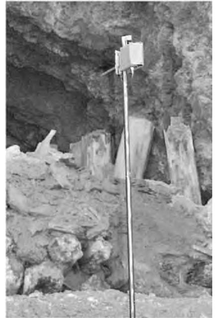
Ein Ultraschalldatensammler ist vor einer Mine positioniert, um in der Nacht alle Rufe der ein- und ausfliegenden Fledermäuse aufzuzeichnen. Am einsturzgefährdeten Mineingang können aus Sicherheitsgründen keine Fledermaus-Fangnetze gestellt werden.
